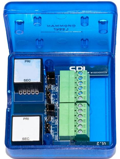
Mittels Jumper kann bei beiden Kanälen die Eingangsimpedanz zwischen 300 Ohm (DC-Widerstand 67 Ohm, Position LOW) und 600 Ohm (DC-Widerstand 134 Ohm, Position HIGH) umgeschaltet werden, um eine Pegelanhebung +6dB zu erreichen.
